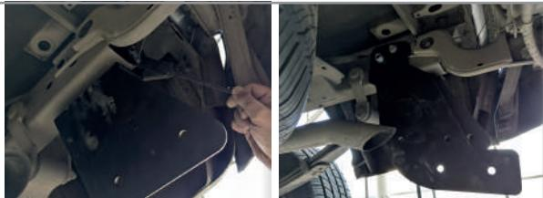
**ШАГ 4.** Вставьте большую закладную деталь в правый лонжерон так, как показано на схеме. Установите правый дополнительный кронштейн на шпильки закладной, используя шайбы 12, шайбы 12 гроверные и гайки M12x1,25.
